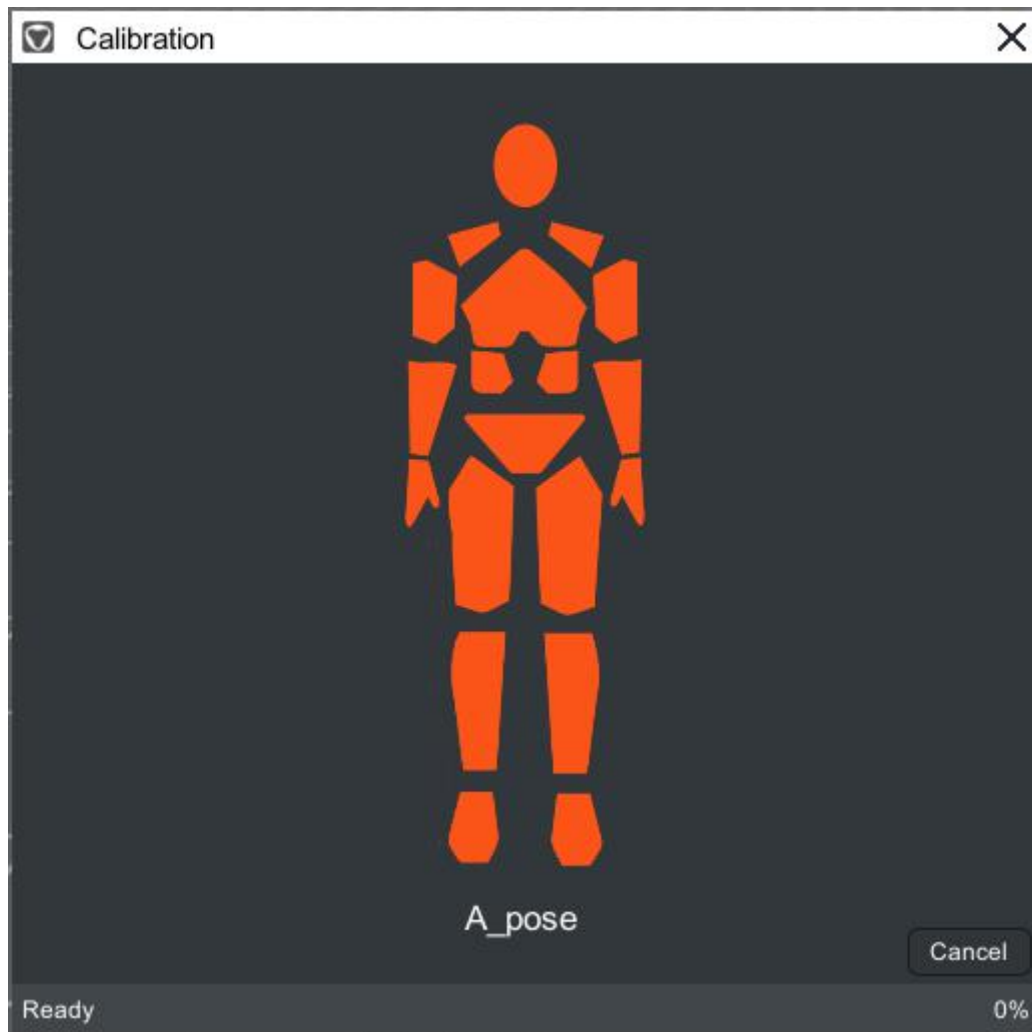
图 1 VDSuit 动捕设备 A_pose 标定。所述 A_pose：站立，双腿伸直平行，双脚指向正前方，双手垂下伸直，双手平行且手心相对。注意：在标定过程中不可往前或往后倾斜，也不可弯背。
