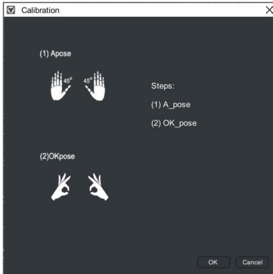
图2 mHand 动捕设备 A_pose 及 OK_pose 标定。所述 A_pose：双手放平，掌心向下，除大拇指外四指平行并拢，大拇指与食指夹角 45 度。所述 OK_pose：大拇指指尖与食指指尖接触形成一个圆圈，其它手指伸直。
